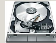
このような原因によりヘッドが誤作動を起こしたり、スクラッチと呼ばれる傷をディスクにつけてしまい、HDDが故障します。
